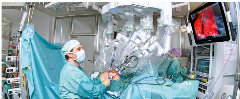
[Abb. 1] Während robotischer Operationen werden die Bewegungen des*der Konsolenchirurg*in auf die Roboterarme übertragen, durch die Bedienkonsole ist das Operationsgebiet dreidimensional sichtbar. Das patientennahe Operationsteam besteht aus einem*einer chirurgischen Assistent*in, der*die Instrumente in den Roboterarmen wechselt und über Arbeitstokare assistiert, OP-Pflege sowie anästhesiologischem Personal. Foto: Universitätsklinikum Dresden/Thomas Albrecht
